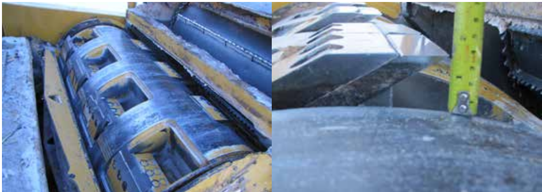
Figure 5 - Disposition des couteaux en configuration double (à gauche) et saillie des couteaux (à droite).
